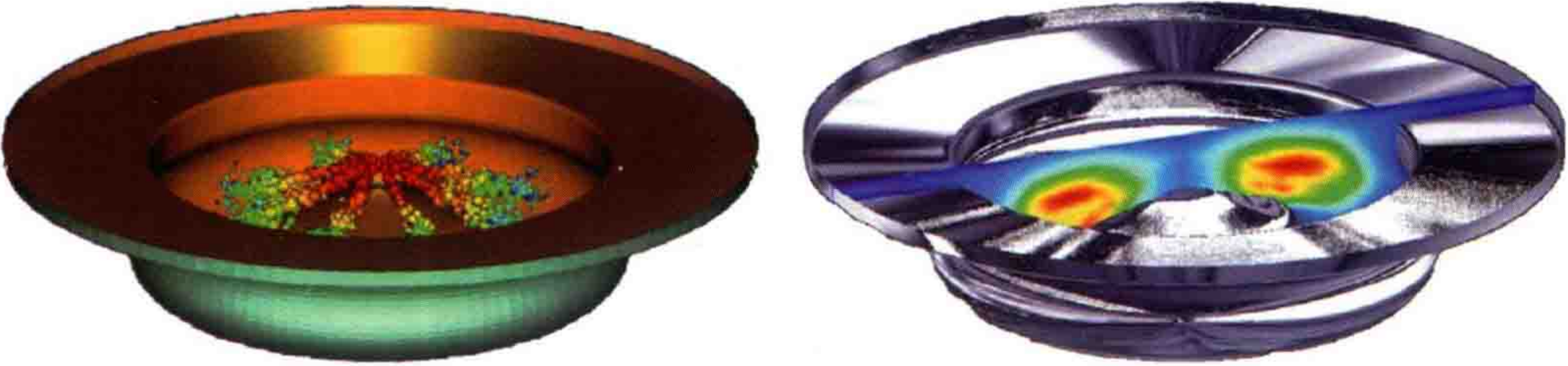
图 27 缸内燃油直喷发动机燃烧室中燃油油滴分布和相关变量的仿真结果
