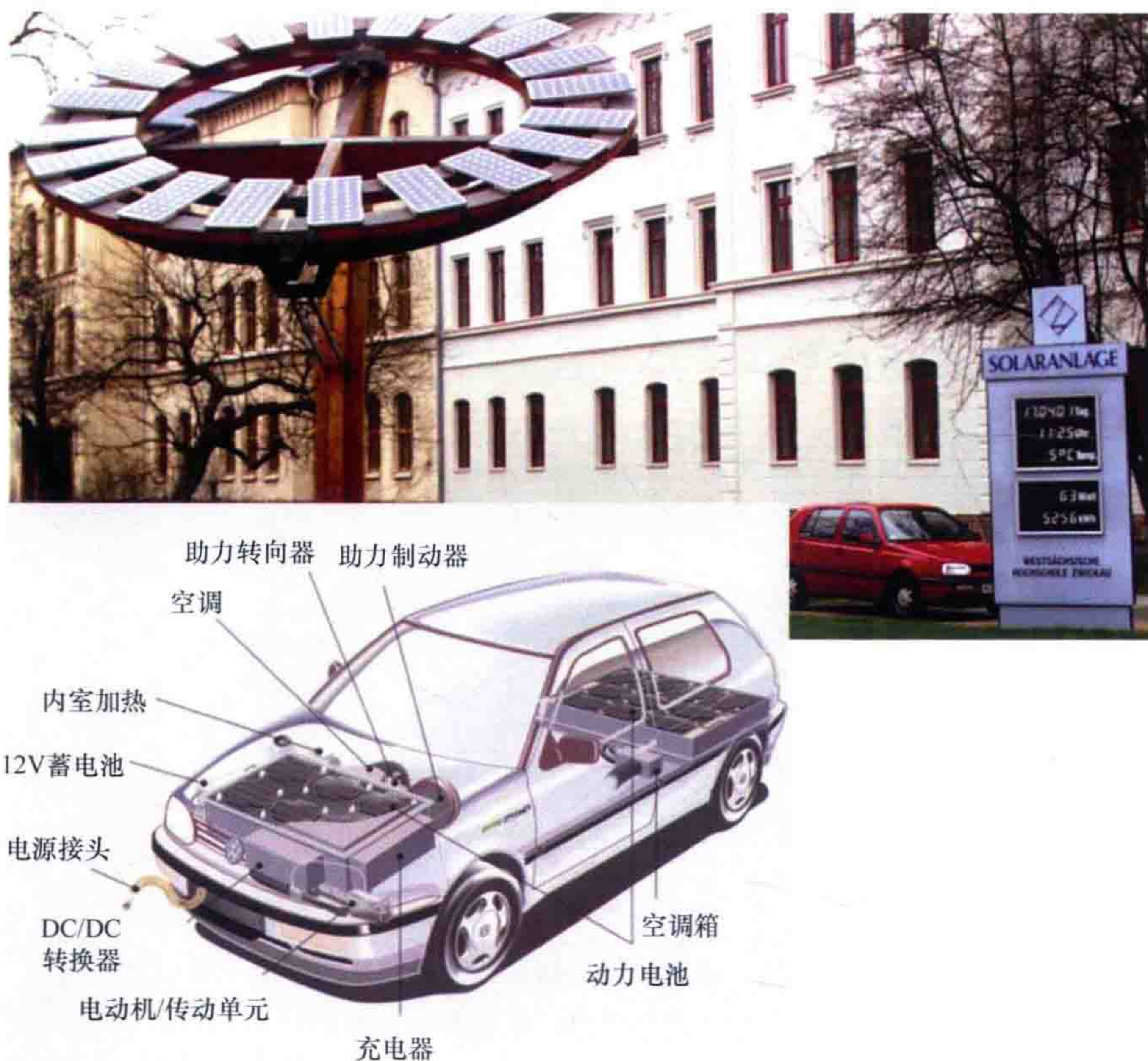
图 18 德国 Zwickau 一所大学应用太阳能给电动车供电的实例
