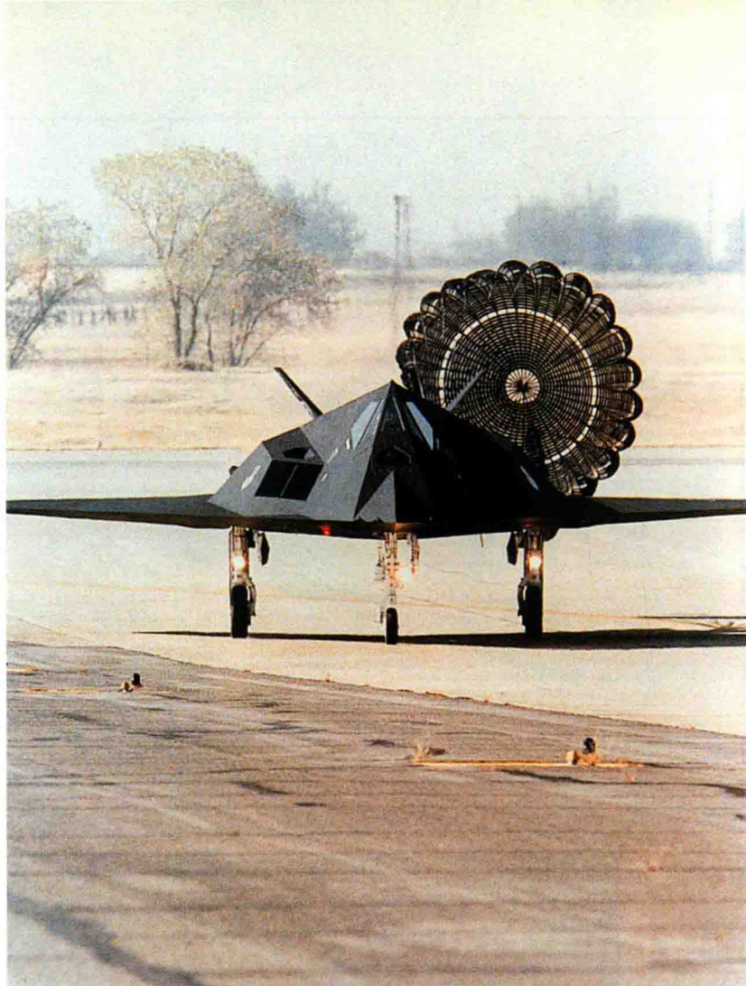
F-177A 在跑道上降落，它的尾部打开了着陆伞，平稳地降落在跑道上。
