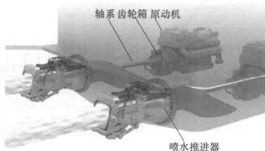
图 1.12 喷水推进装置的结构布置示意图
