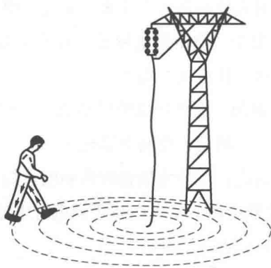
图 1-2 跨步电压触电
