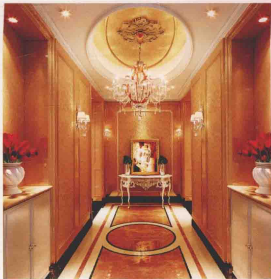
顶面 [石膏板造型 + 石膏浮雕刷金箔漆]
