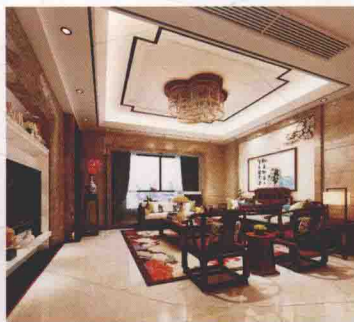
顶面 [ 石膏板造型勾黑缝 ]
