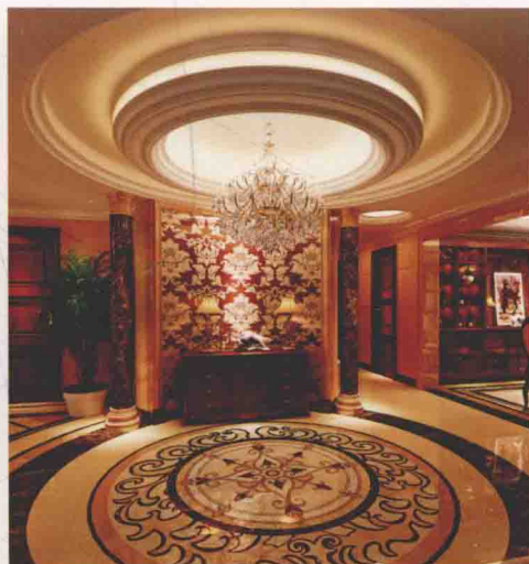
顶面 [ 石膏板造型暗藏灯带 ]
