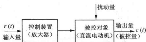
图 1-3 开环控制系统原理
