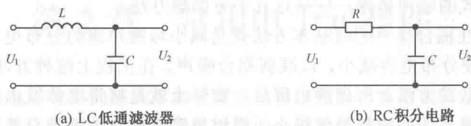
图 1.3.1 抑制传导噪声的滤波电路
