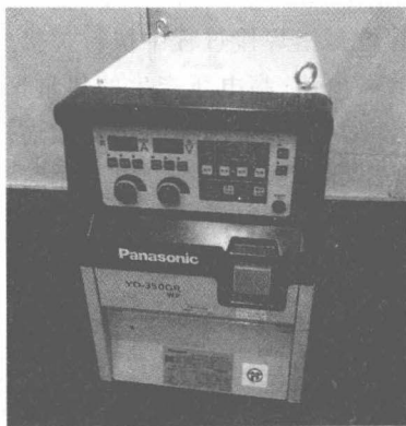
图 1-15 松下公司 YD-350GR 焊机
