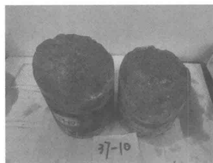
图 2.5 单轴压缩试验后的夹层试样
