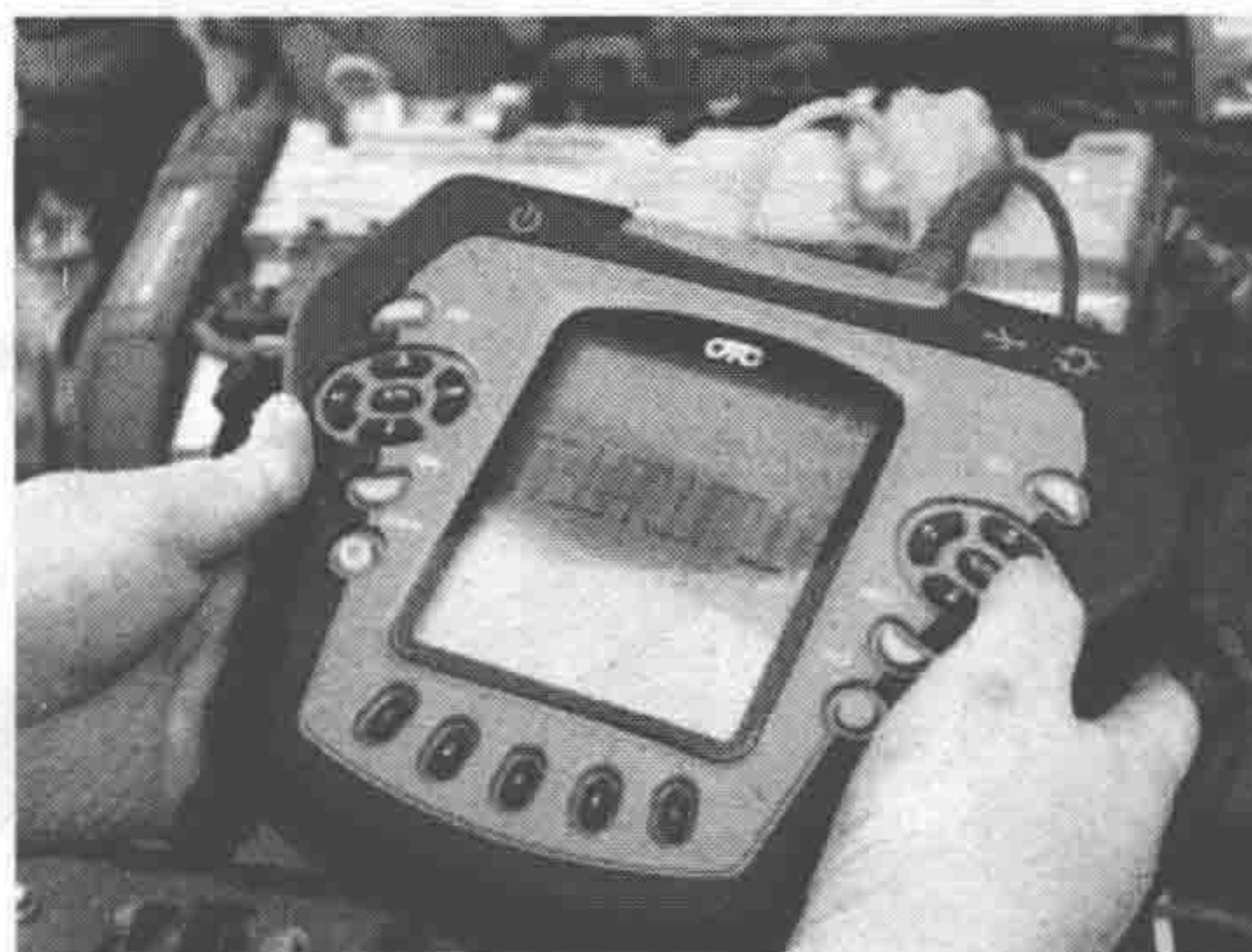
图 1-17 汽车专用的示波器
