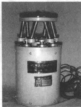
图 1-7 六自由度并联机构补偿器
