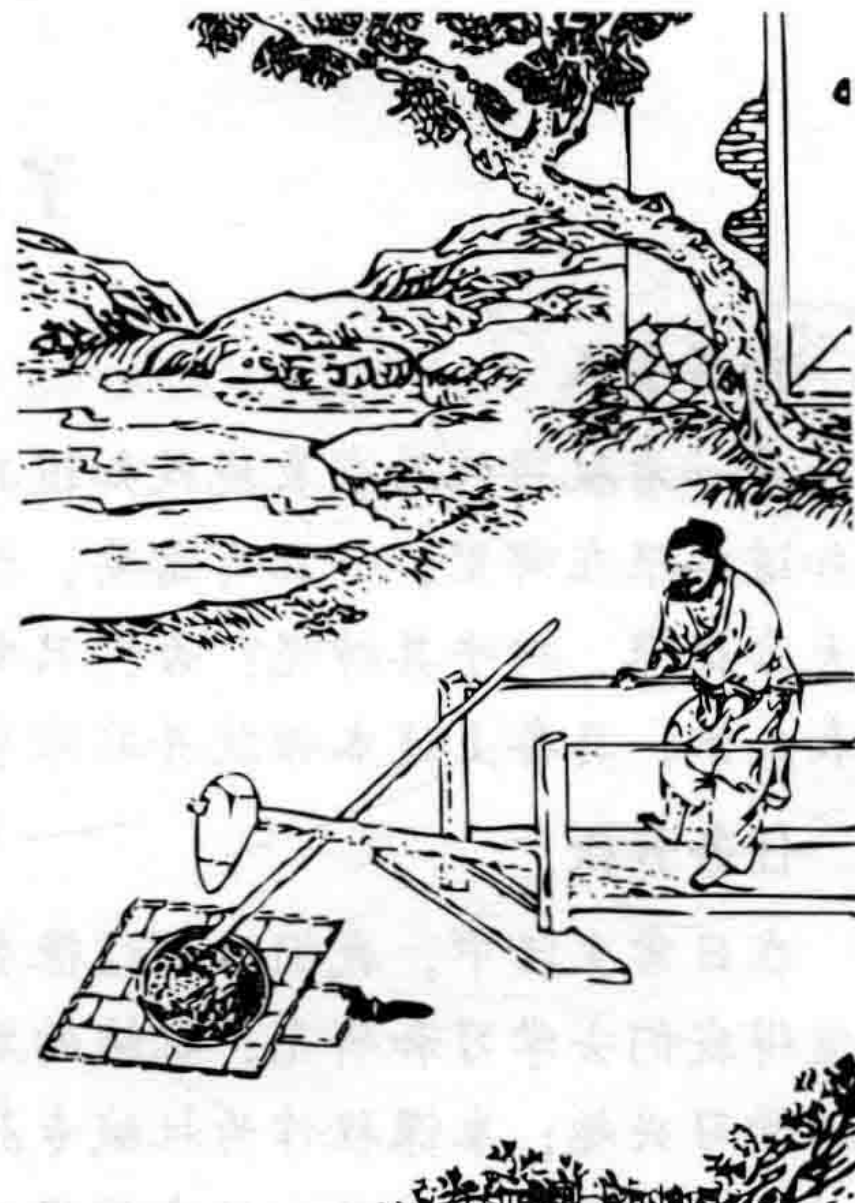
图 1-1-2 连杆碓舂米机构
