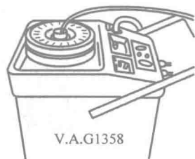
图 1-18 液力变矩器的排空操作
