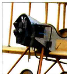
座舱前外露的排气集管和发动机缸盖
