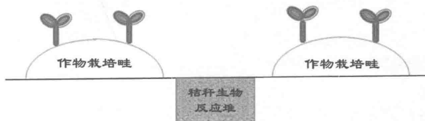
图 1-3 秸秆生物反应堆——行间内置式
