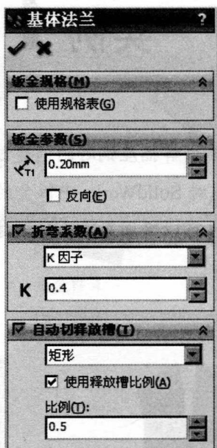
图 1.4 “基体法兰”对话框
