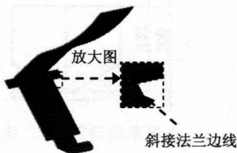
图 1.14 斜接法兰边线
