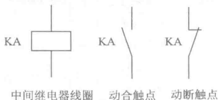
图1-7 中间继电器的文字符号和图形符号
