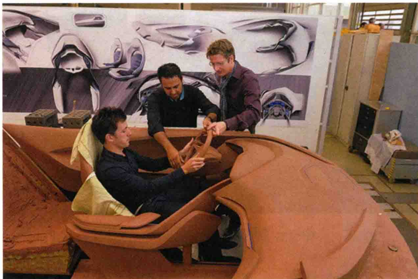
图 1-7 模拟和模型试验法——使用者对产品模型进行试验与评估
