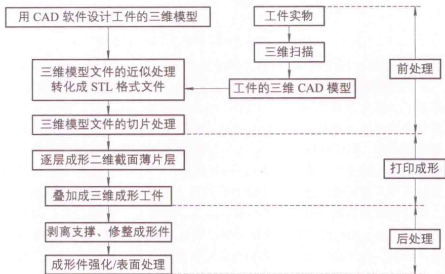
图 1-3 3D 打印技术的全过程
