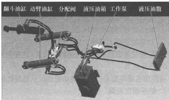
图 1-9 装载机工作装置液压系统
