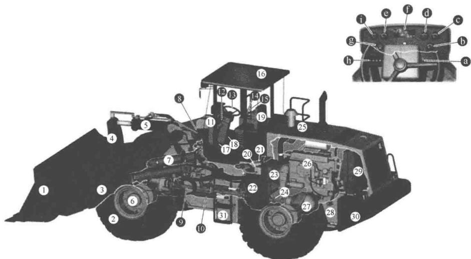
图 1-4 ZL50G 装载机的结构组成
