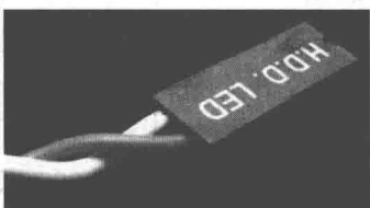
图1-15 硬盘状态指示灯连线
