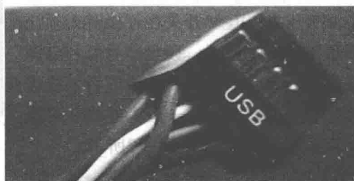
图1-17 前置USB接口连接线
