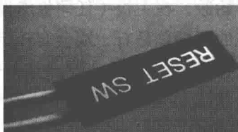
图1-14 机箱前面的复位按钮连线
