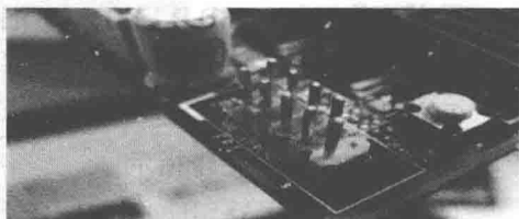
图1-20 9Pin定义开关/复位/电源灯/硬盘灯面板接口实物图
