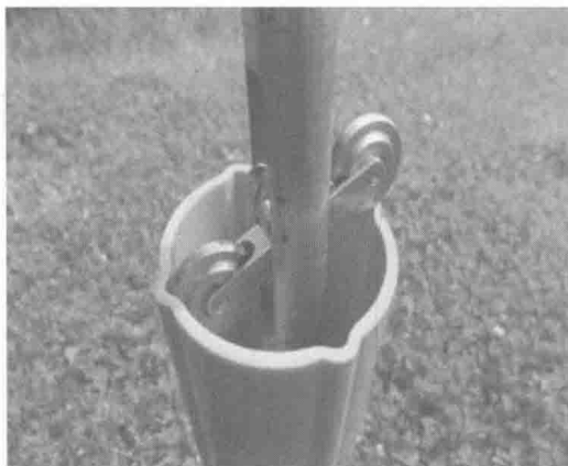
图 1-5 探头卡入滑轨槽道
