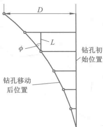
图 1-1 测斜仪的测量原理
