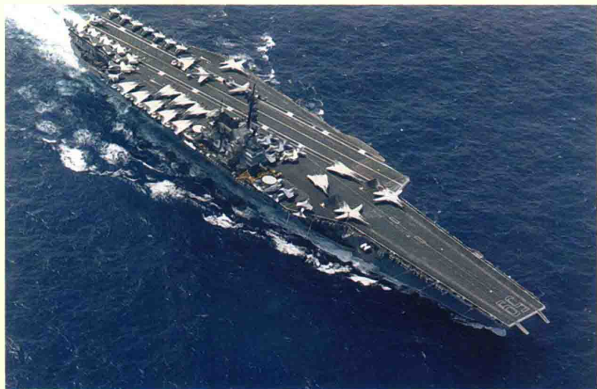
▲ “福莱斯特”号航空母舰，为美国最早采用斜角式甲板的航空母舰，也是世界上第一艘专为喷气飞机起降设计而建造的超级航空母舰
