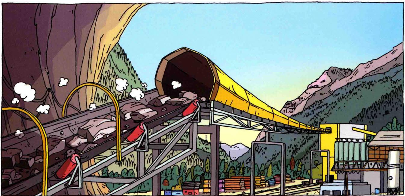
挖出的岩渣通过皮带运输机被源源不断地运送到隧道外。
