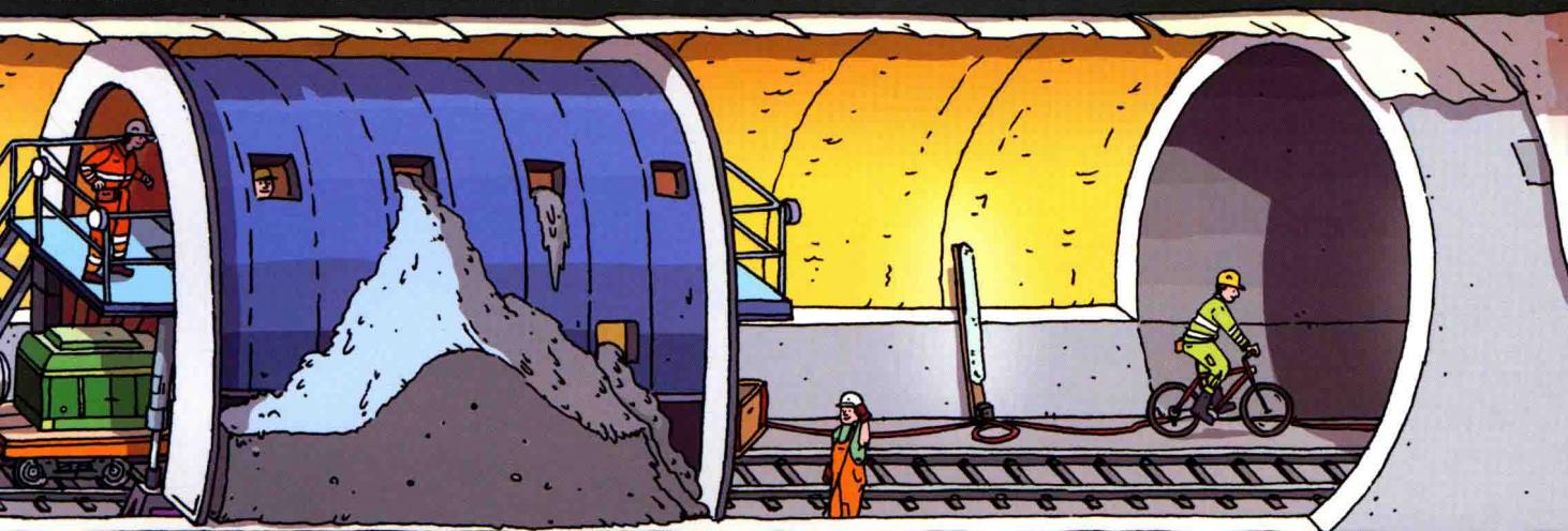
模板台车沿隧道洞身浇筑一层 30 厘米厚的混凝土，这项作业要分段进行。
