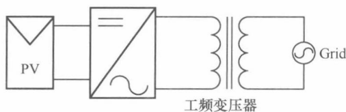
图 1.2 带工频隔离变压器的并网逆变器
