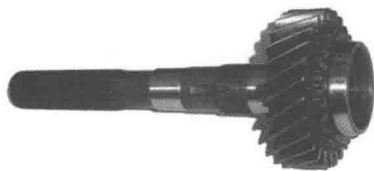
图 9 变速器输出轴与接合齿轮整体结构的齿轮轴
