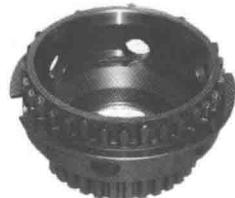
图 12 带外花键和接合齿的差速器壳体
