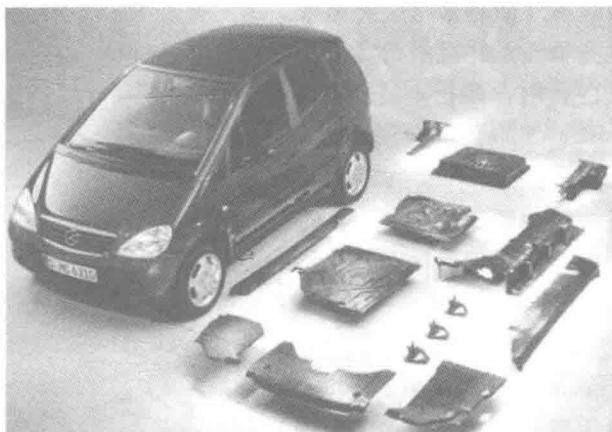
图 1.3 使用天然纤维/树脂基复合材料制作的轿车内饰件 [12,13]
