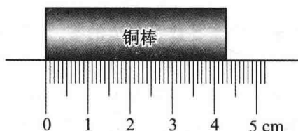
图 1-2-2 用毫米分度尺测量铜棒的长度
