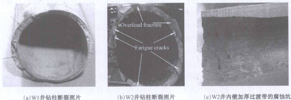
图 1.5 钻柱断裂失效照片 [29]
