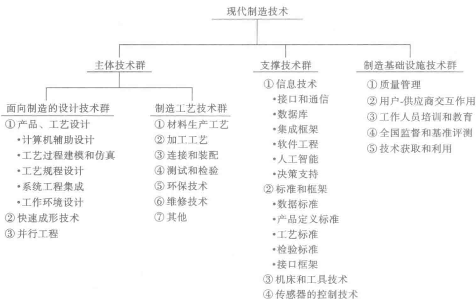
图 0-1 现代制造技术的体系结构
