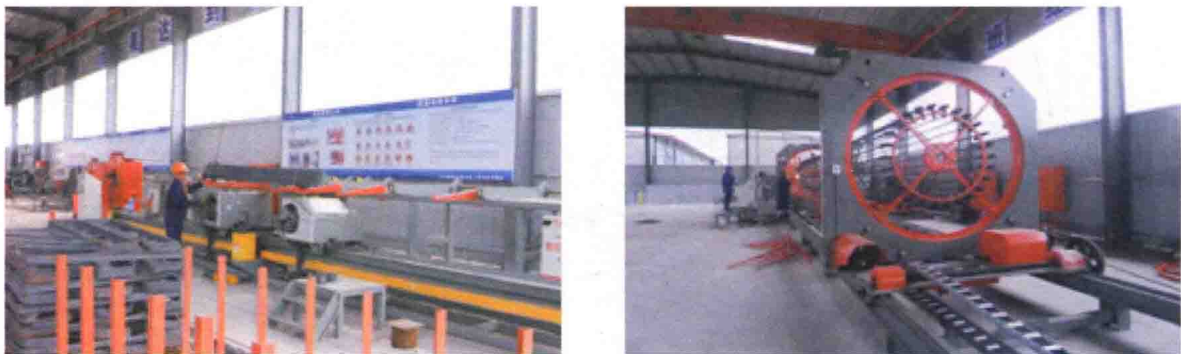
图 17 全自动数控弯曲机和钢筋笼滚焊机实例
