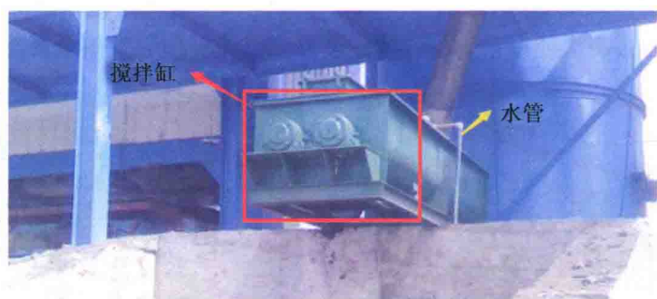
图 11 回收粉加湿装置实例
