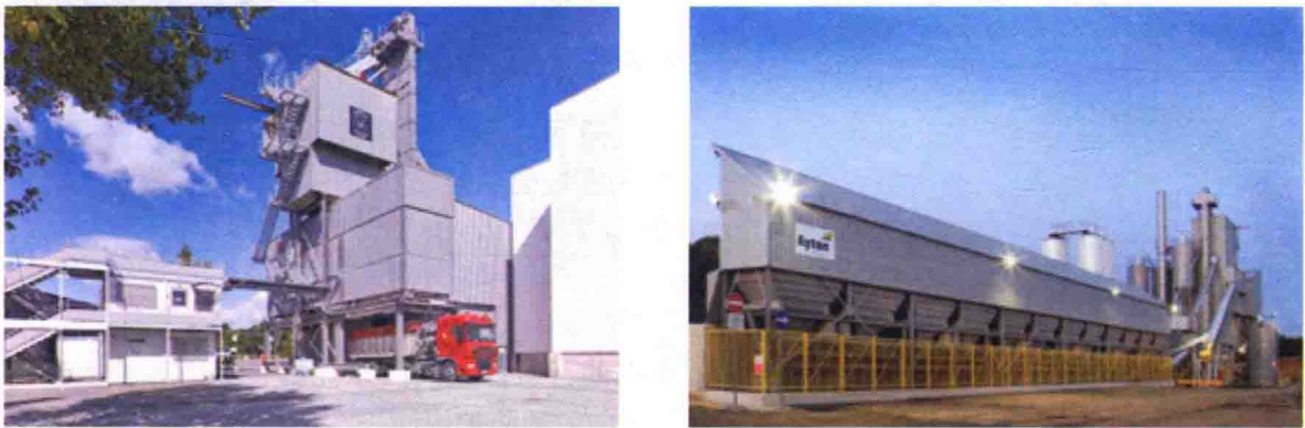
图10 全封闭沥青拌和站实例
