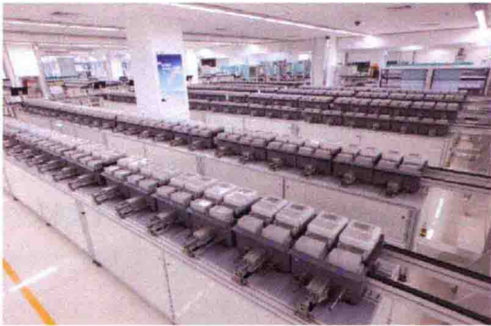
图 1 配备三相标准电能表的智能电能表检定装置
