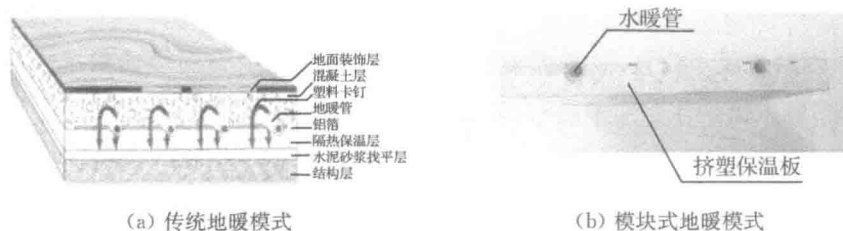
图 1.11 两种地暖模式示意图
