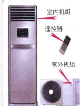
落地式空调器又称柜机，其结构与壁挂式空调相同，只是室内机的形状和摆放方式类似柜子。通常，柜式空调比壁挂式空调的制冷功率更大，能够满足面积较大房间温度调节的需求。特点是制冷量大。
