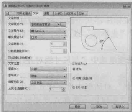
图 1-28 设置“角度标注”文字的对齐方式
