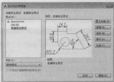
图 1-24 创建“机械标注样式”
