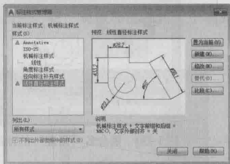
图 1-35 创建“线性直径标注样式”
