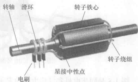
图1-10 异步电机的绕线式转子
