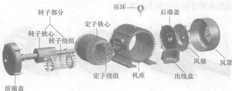
图 1-7 鼠笼式异步电机主要结构部件
