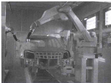
图1-20 喷涂机器人在汽车表面喷涂作业
