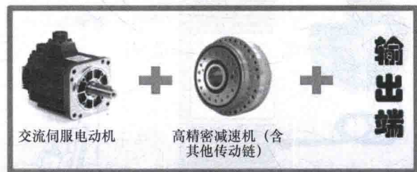
图1-5 机器人运动关节的组成
