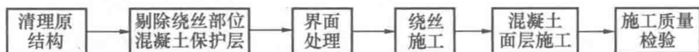
图 1-3 混凝土构件绕丝施工工艺流程
