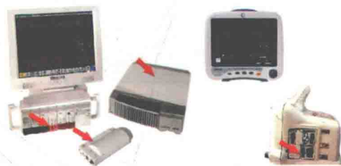
图 1-1-2 飞利浦公司 MP90(左,单个插件式)和 GE 公司 DASH400 整合模块(右)
