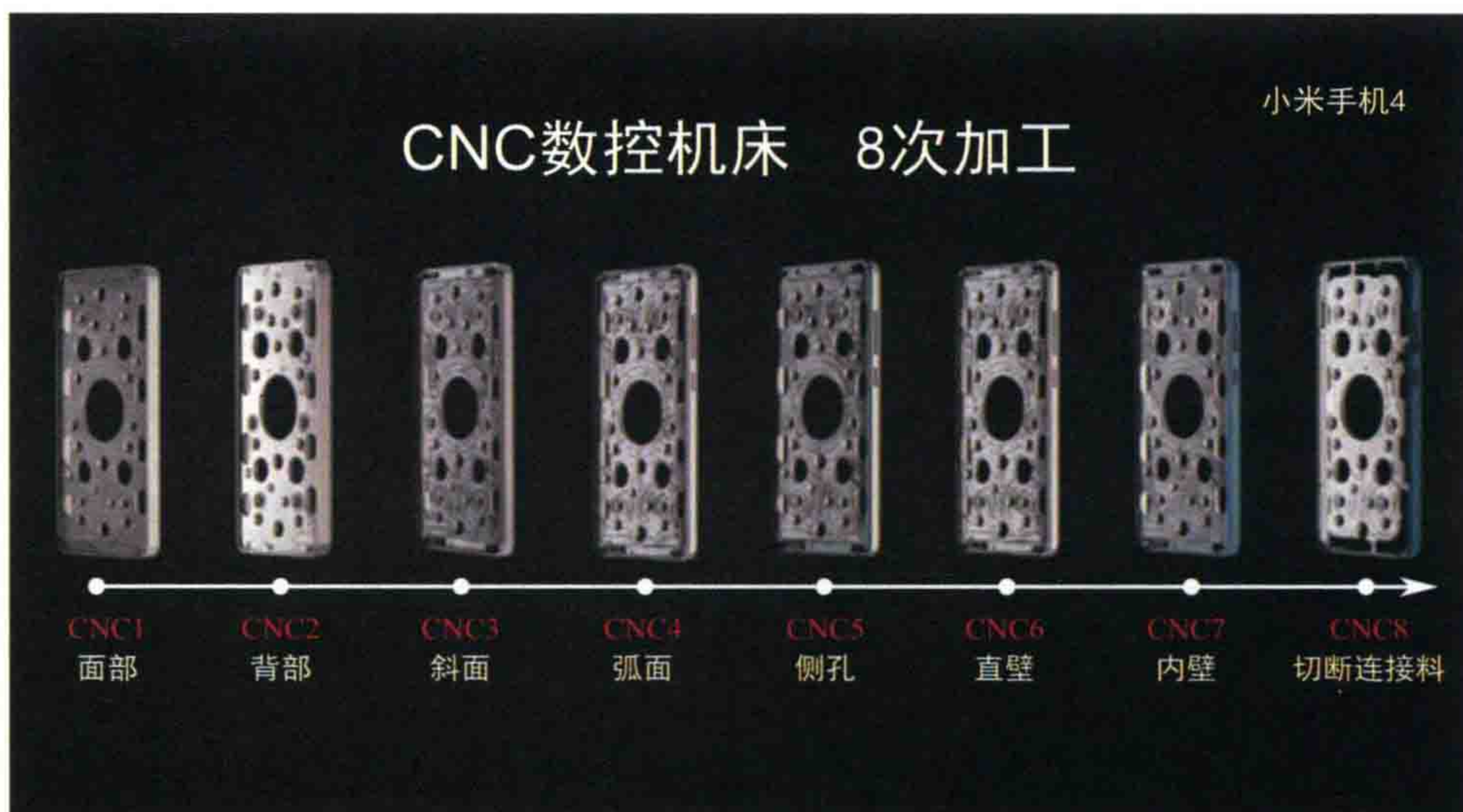
图 2-3 手机壳的减材制造工序
