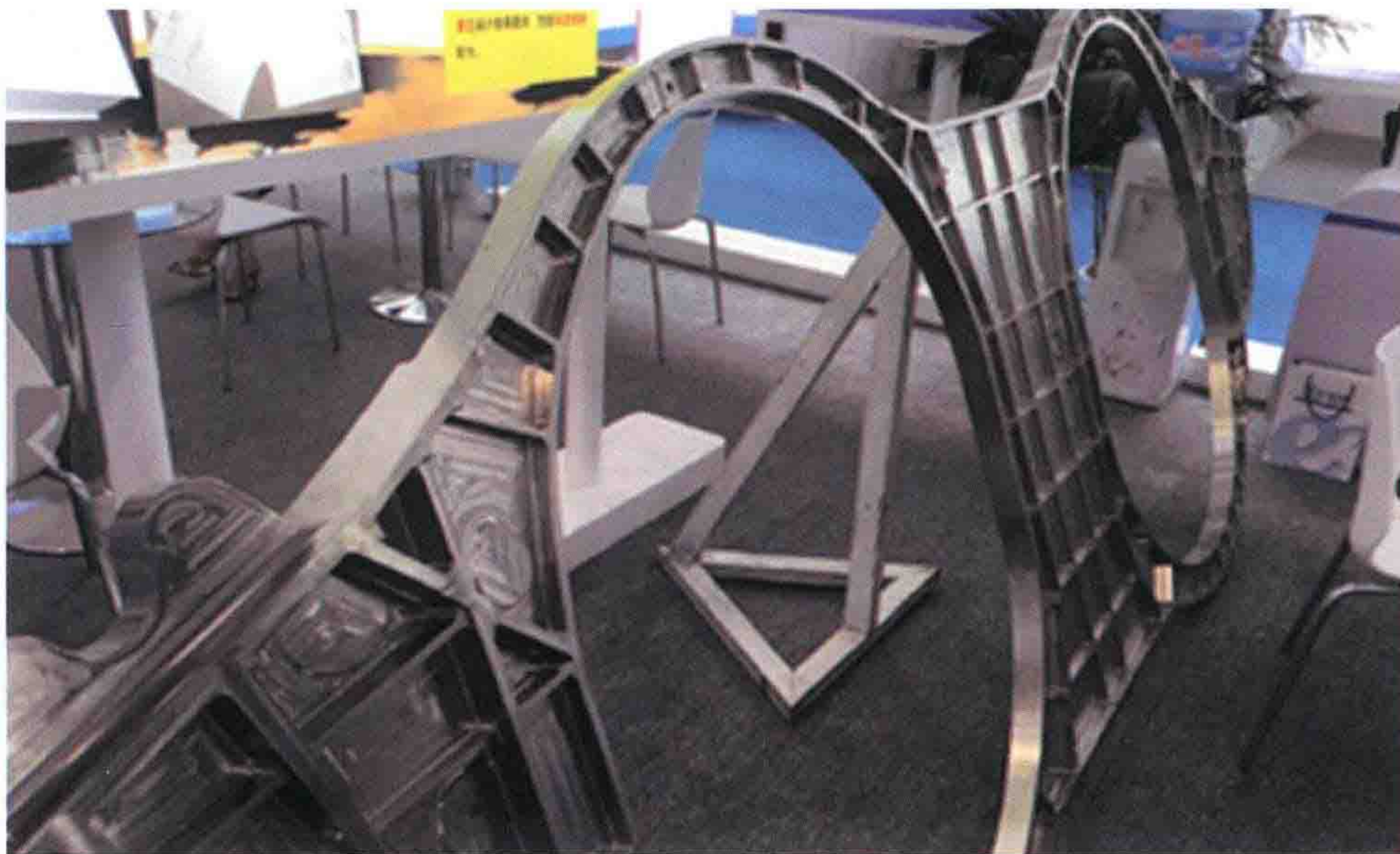
图 2-2 钛合金大型整体构件
