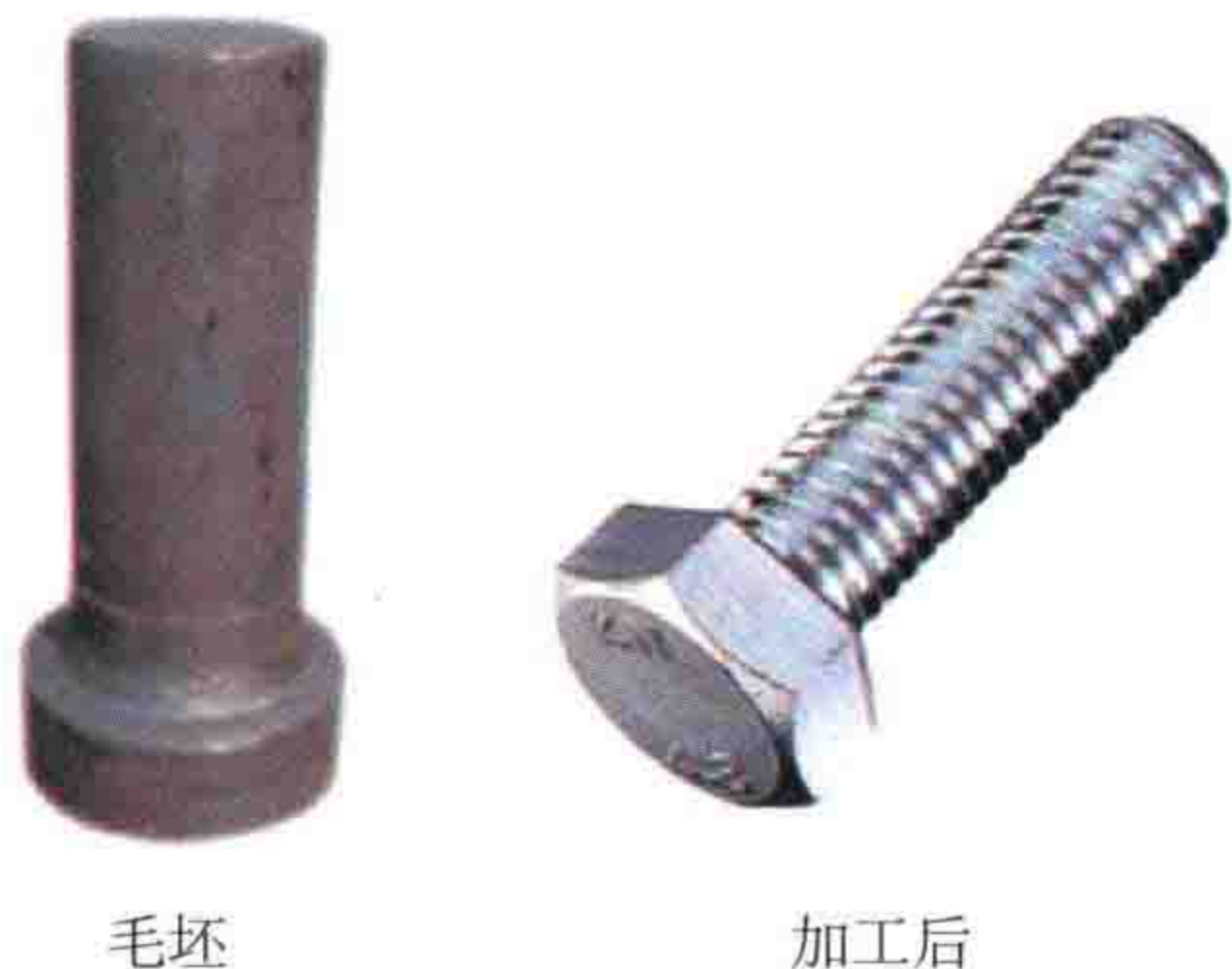
图2-1 螺栓的毛坯和成品
