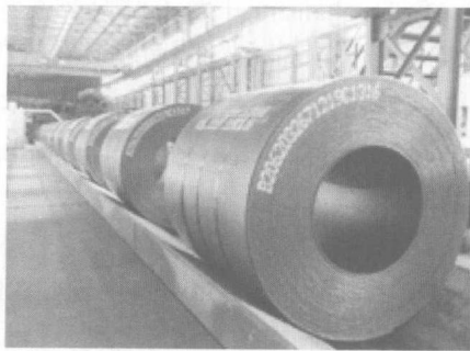
图 1-6 引进的国外连铸机生产的薄板坯连铸连轧产品
