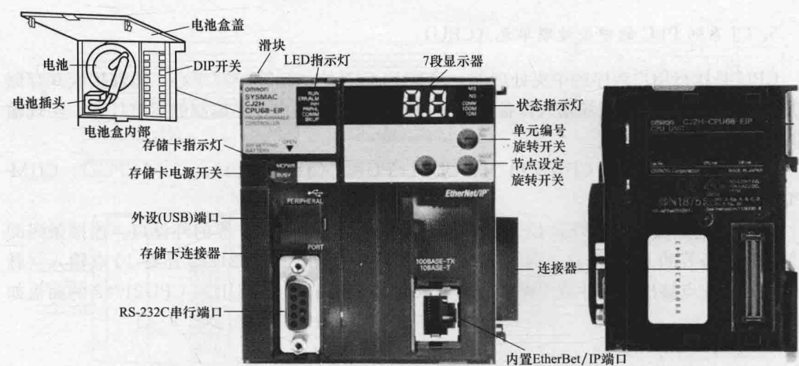
图 1-8 CJ2H-CPU68-EIP 的面板
