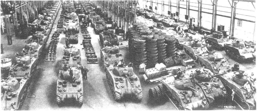
威廉·克努森中将在福特汽车厂发明和推广的流水线，使得制造业的生产能力发生了飞跃，上图为底特律某汽车厂坦克生产车间的流水线现场
