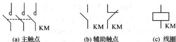
图 1-6 接触器的图形符号和文字符号
