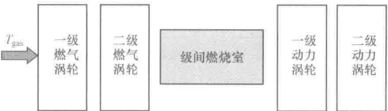
图 1-21 涡轮级间驻涡燃烧室原理示意图
