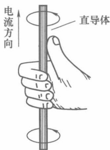
图 1-6 用右手螺旋定则判断通电 直导体的磁场方向
