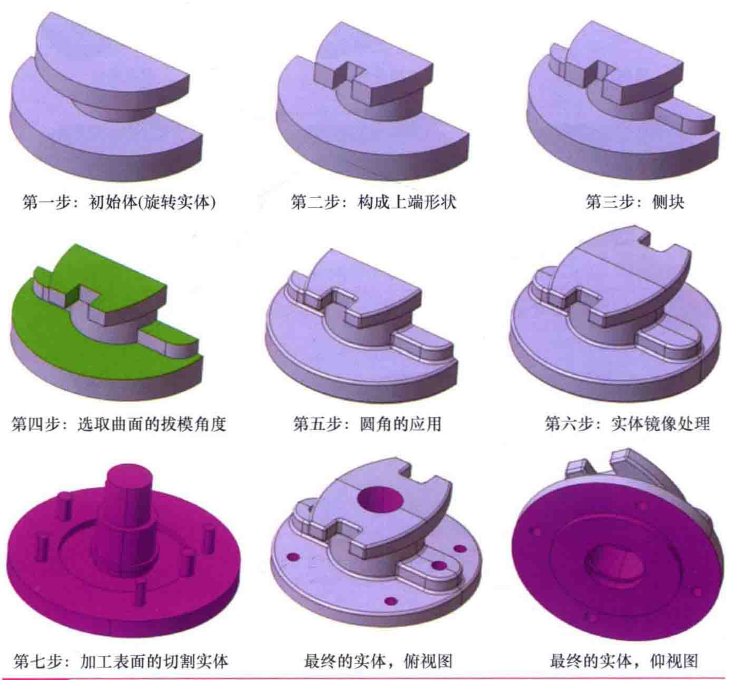
图 4-40 阀盖的示范性设计步骤
