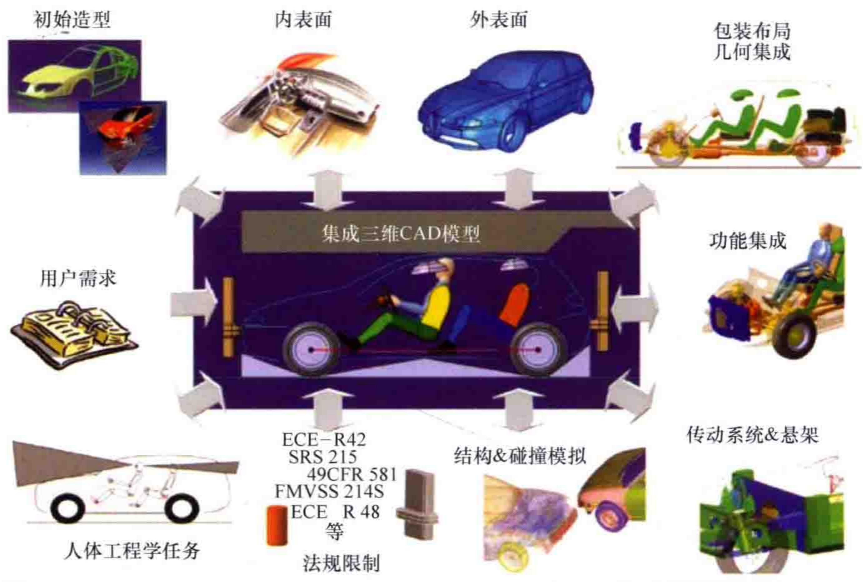
图 9-11 早期开发阶段中影响集成三维 CAD 模型的因素 [1]
