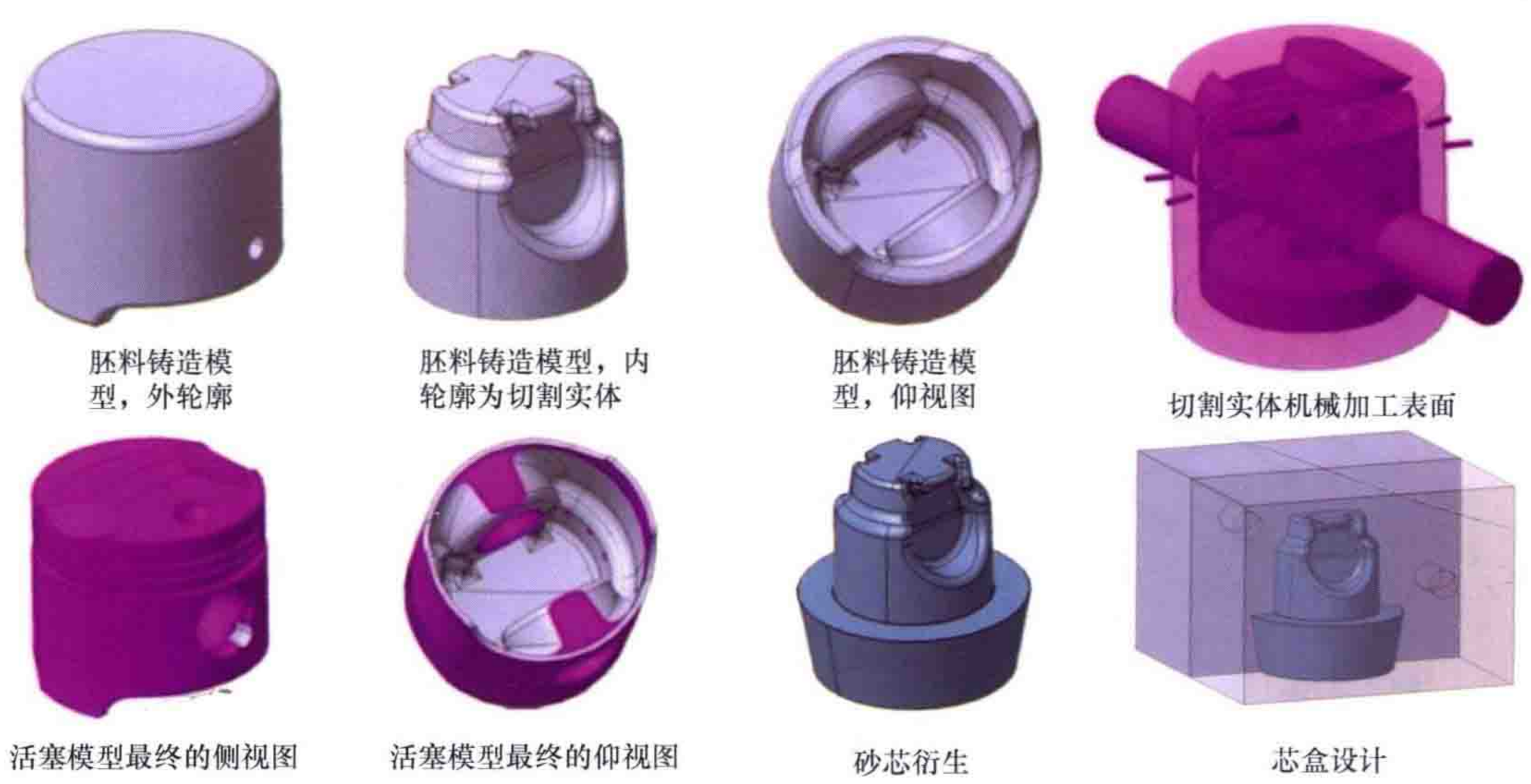
图 4-37 布尔运算活塞生产相关模型的应用
