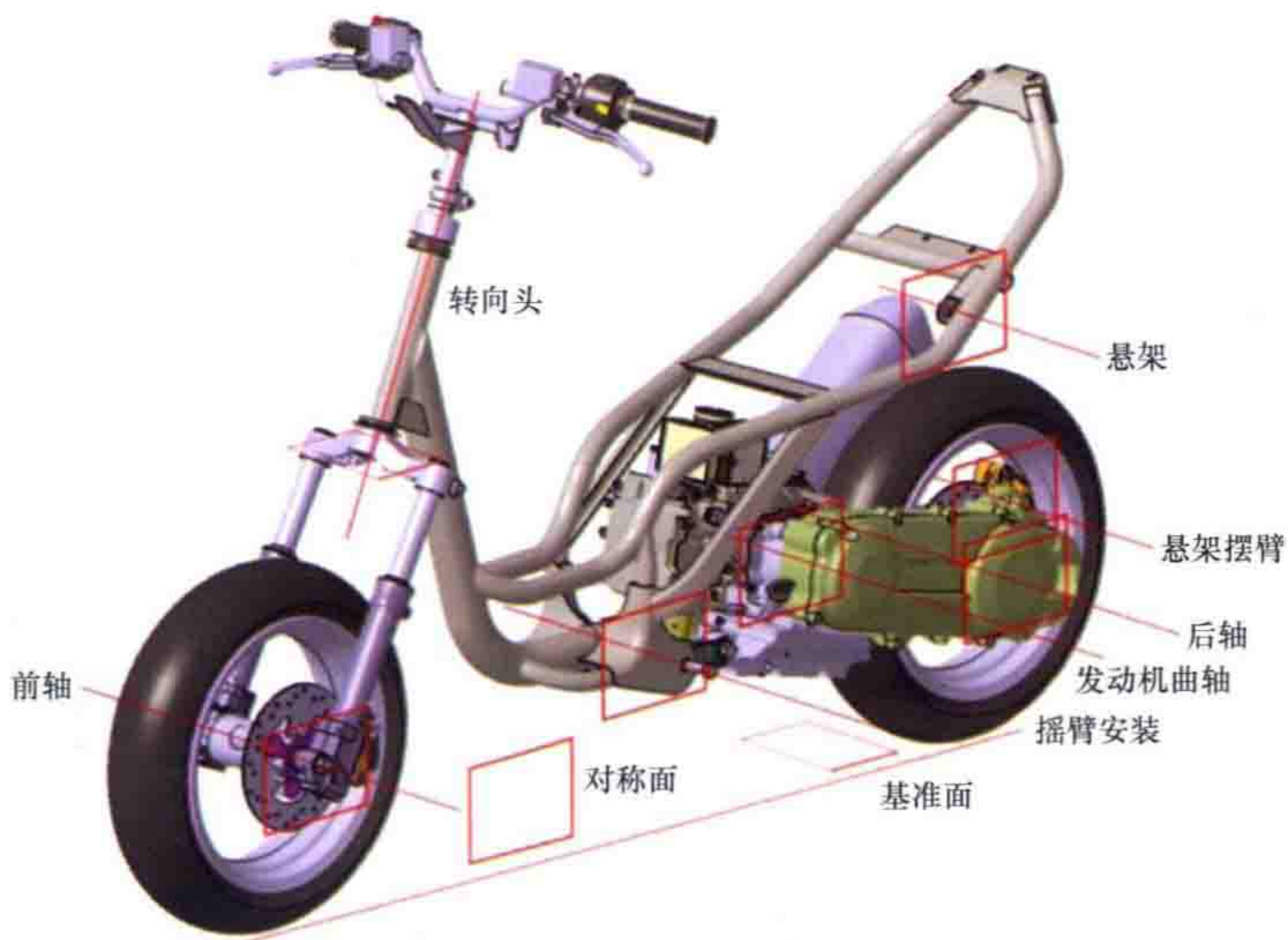
图 4-51 摩托车装配的骨架模型元素
