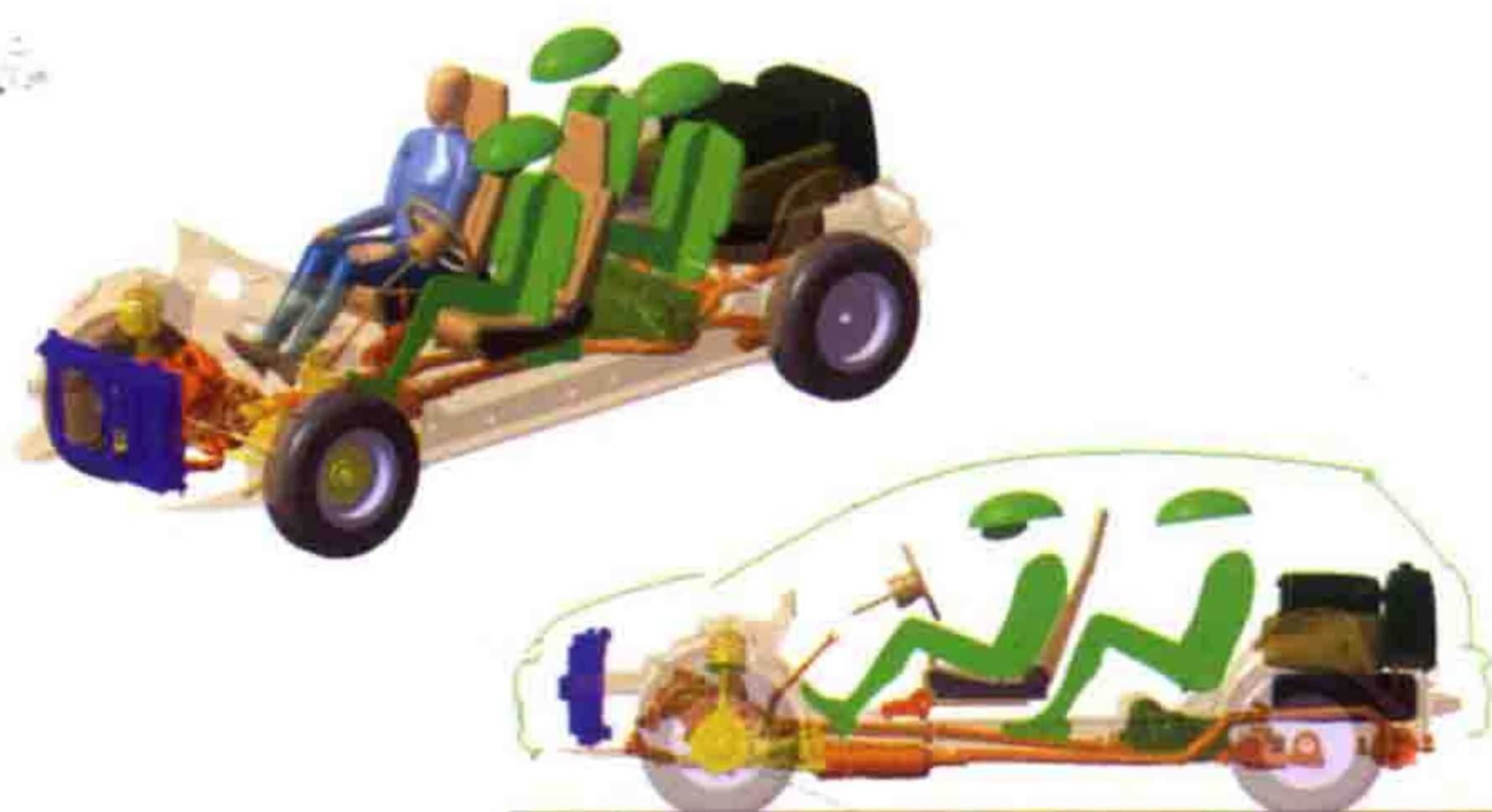
图 9-22 导入几何结构的封装研究
