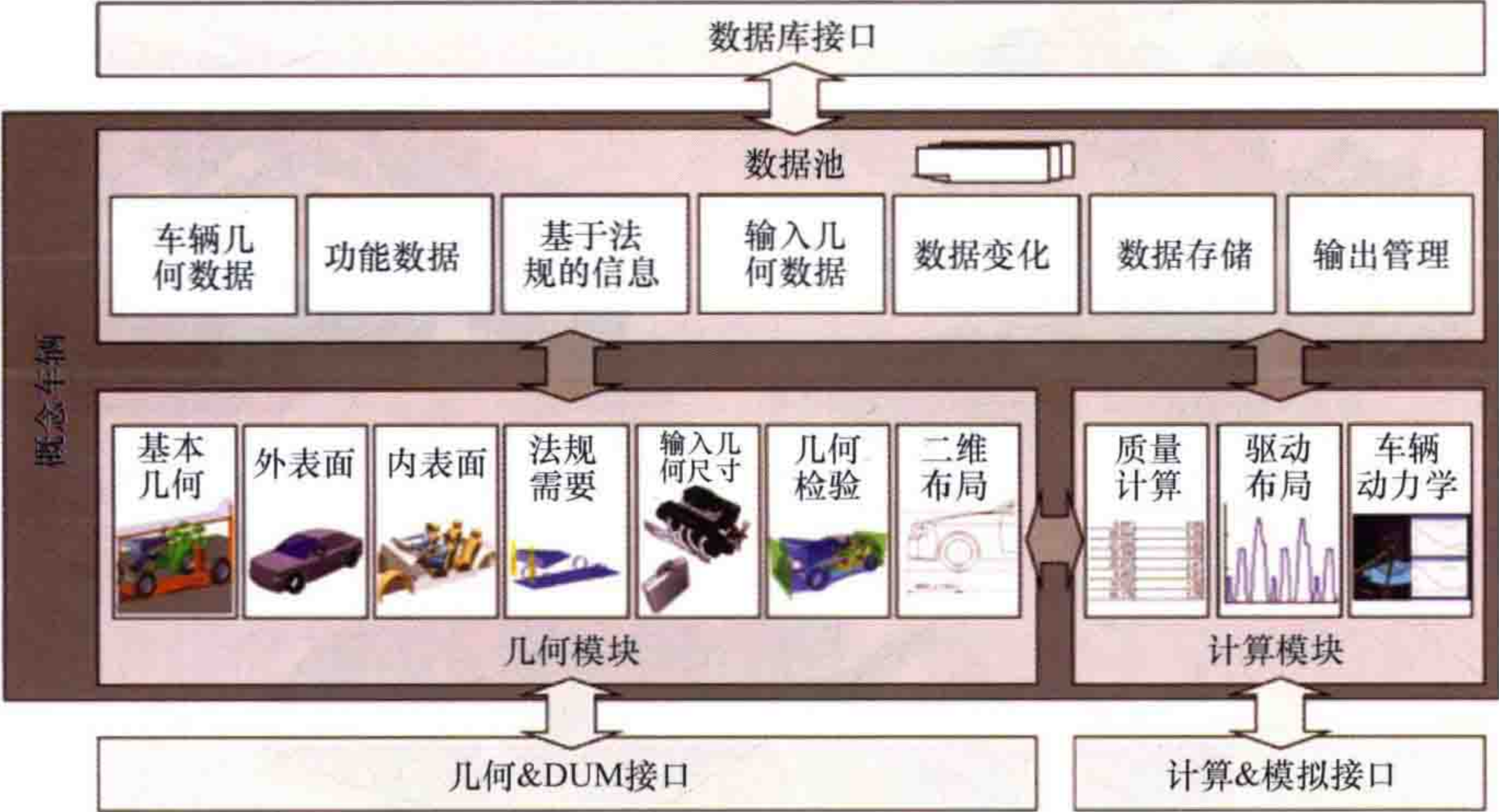
图 9-14 概念工具的原理架构
