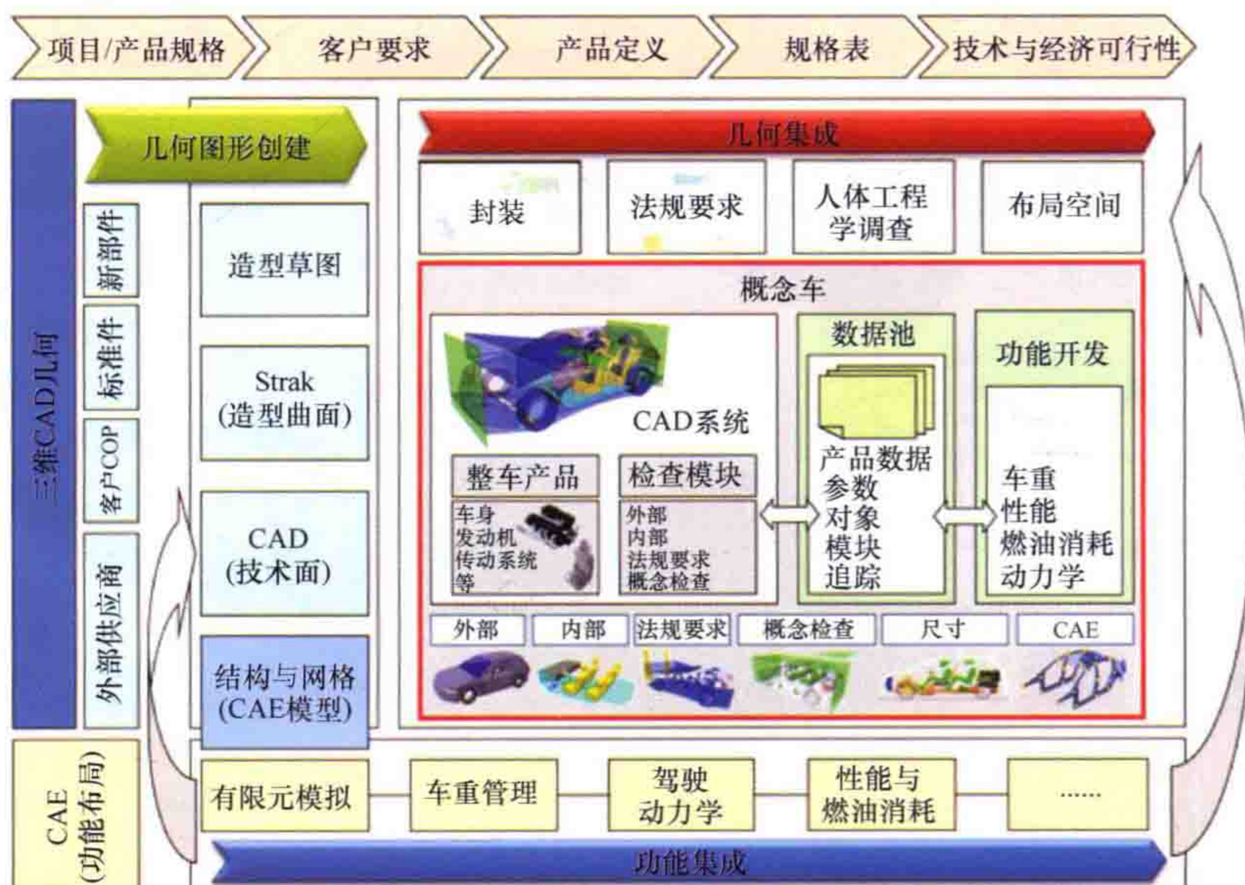
图 9-25 生产流程中虚拟概念车的模块和功能 [20]
