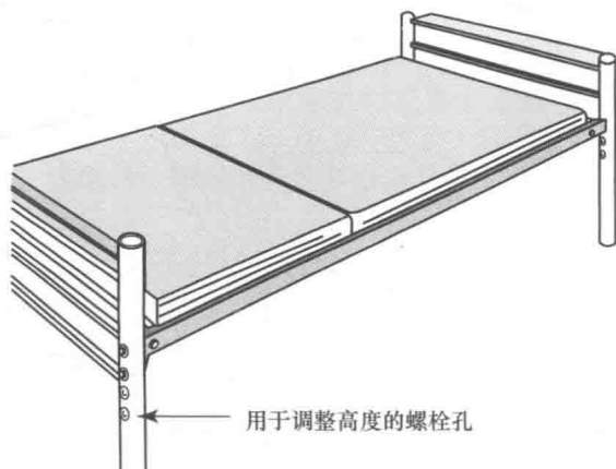
图 1-1-2 机械连接法（螺栓紧固）的优点
