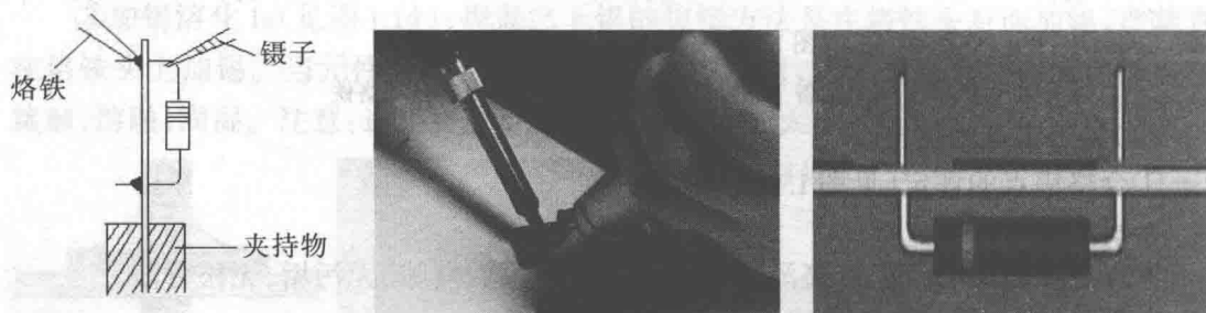
图 1.20 电烙铁拆卸元件操作
