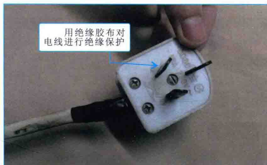
图1-13 电气设备供电线缆插头的检查
